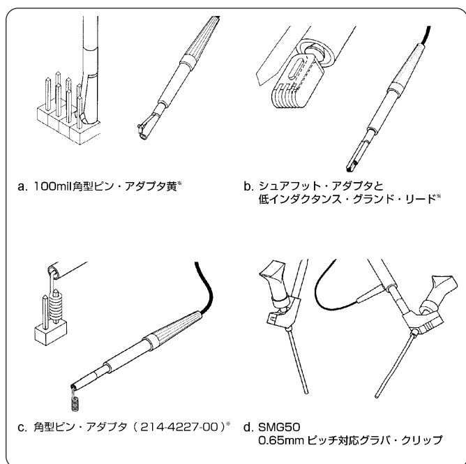
▶ 図2-15. 小型形状プローブ用チップ・アダプタの例。こうしたアダプタによって、小型回路のプロービングが簡単になり、テスト・ポイントへの確実な接続によって測定精度も向上します。
