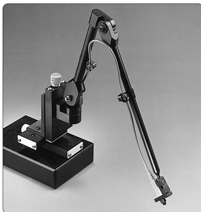
▶ 図2-10. ハイブリッド回路やICのような小型形状デバイスをプロービングするためのプロービング・ステーションの例
