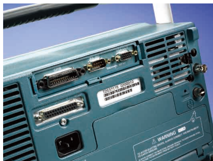
図52. セントロニクス・ポートを標準で装備していたり、オプションでEthernet/RS-232、GPIB/RS-232、VGA/RS-232のインタフェース・モジュールを挿入しているオシロスコープもある。前面パネルにUSBポートを装備しているものもある
