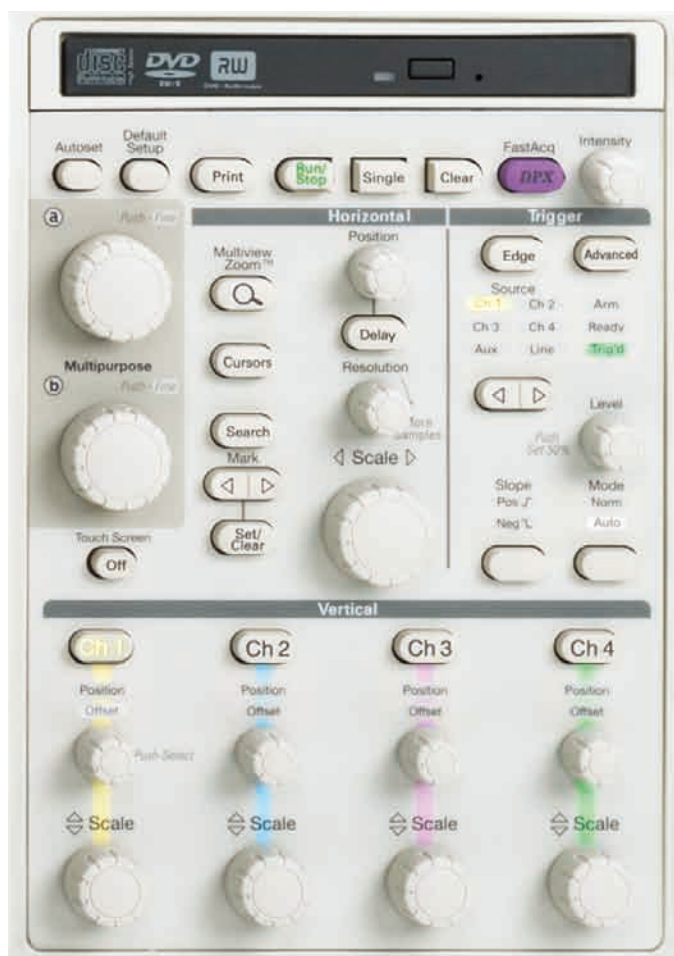
図19. オシロスコープの前面パネル操作部
