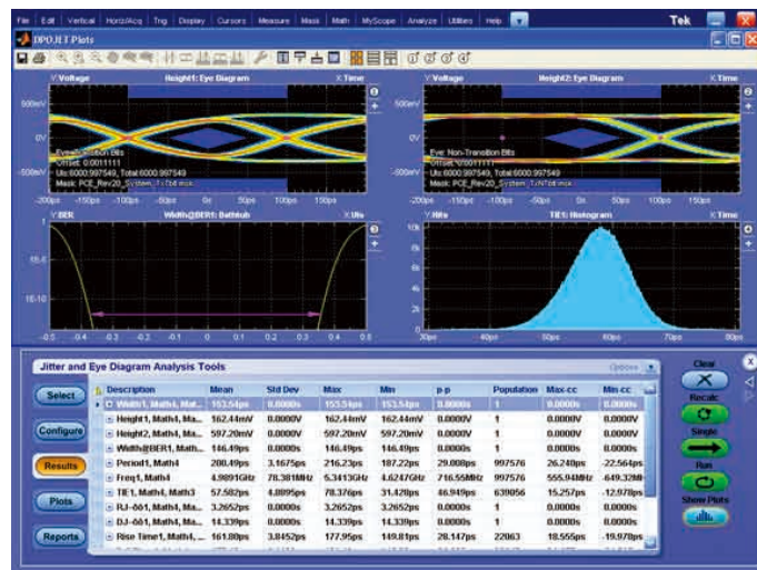
図53. 解析ソフトウェアは、最新のハイスピード・デジタル設計で必要となるジッタ/アイ・ダイアグラム測定に最適
