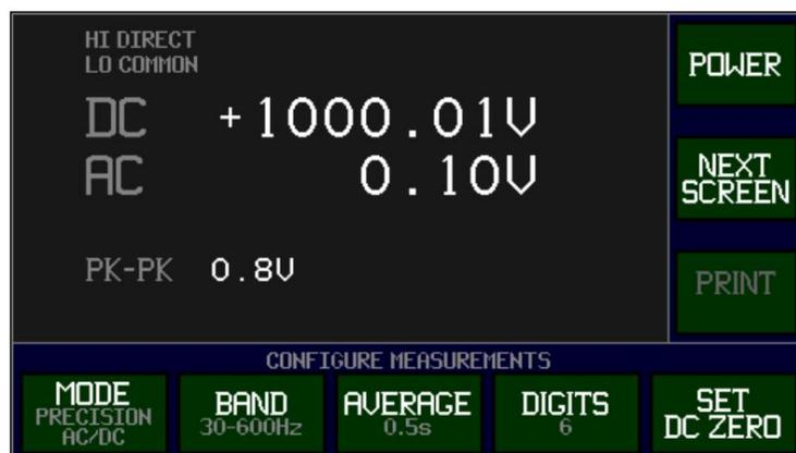
この画面のメインセクションには、4700に選択された入力端子と測定結果が表示されます。入力が過負荷状態の場合、過負荷状態の入力端子名が赤で表示され、測定結果も表示されます。赤で表示されます。
