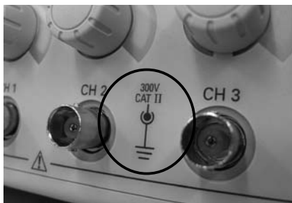
写真6-1 多くのオシロスコープには、入力BNC端子の近くに最大入力電圧が表示されています: このオシロスコープの場合、最大入力電圧は 300Vrms
