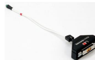
P76TA 30GHz帯域P7500シリーズ・チップ・アダプタ。P75PSTパフォーマンス・ソルダ・チップとこのアダプタを使用することで、プローブとオシロスコープを組み合わせたシステムとして最高30GHzの周波数帯域をサポートします。
