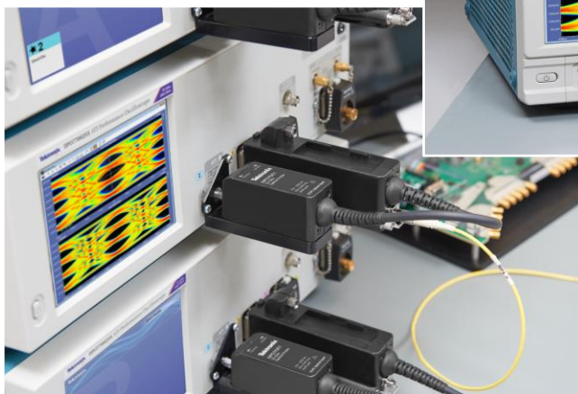
周波数帯域70GHzのDPO70000SXシリーズ・オシロスコープのATIチャンネルに接続したDPO70Eシリーズ光プローブ
