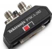
P76CA-292 2.92mm (Fe) コネクタを装備した、33GHz帯域の同軸アダプタです。入力コネクタにおいて校正されているため、市販のケーブルまたは独自のケーブルでの利用に適しています。全帯域性能で使用するためには、スキューの小さなケーブル・ペアを使用する必要があります。
