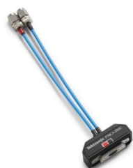
P76CA-292C 2.92mm (Ma) コネクタと15cm (6 inch) の高性能ケーブルを装備した、33GHz帯域の同軸アダプタです。入力コネクタにおいて校正されているため、2.92mmまたはSMA出力コネクタを装備したデバイスとの直接接続に適しています。
