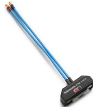
P76CA-SMP SMP (Fe) コネクタと15cm (6 inch) の高性能ケーブルを装備した、33GHz帯域の同軸アダプタです。入力コネクタにおいて校正されているため、SMP出力コネクタを装備したデバイスとの直接接続に適しています。
